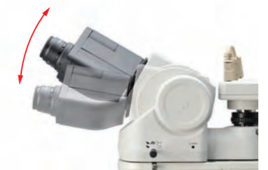
Угол наклона окуляров регулируется от 10° до 30°
