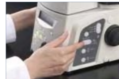
Изменение положения блока светофильтров с высокой скоростью - за 0,25 с
