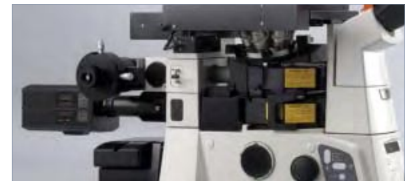
Пример: В дополнение к PFS, установлены модуль фотоактивации (верхний ярус) и задний порт (нижний ярус).
