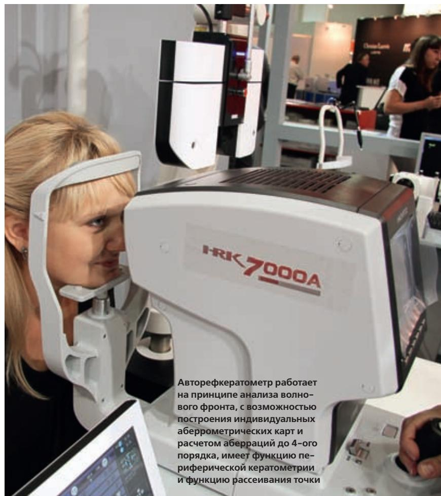
Авторефкератометр работает на принципе анализа волнового фронта, с возможностью построения индивидуальных aberrометрических карт и расчетом aberrаций до 4-ого порядка, имеет функцию периферической кератометрии и функцию рассеивания точки
