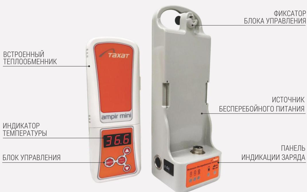
Принцип работы комплекса основан на непрерывном подогреве потока жидкости. Теплообменник нагревает инфузионную магистраль, зафиксированную в нем, и протекающую внутри неё жидкость.
