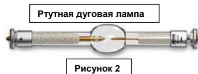
После установки новой лампы включите источник питания и дайте лампе поработать 10 - 15 минут, чтобы она вышла на стабильный режим (**Важное примечание:** при первом включении новой лампы её необходимо **прожечь** в течение часа). Такой прожиг необходим для выжигания канавки в аноде и образования, благодаря этому, пути наименьшего сопротивления, обеспечивающего стабильное, без мерцания, свечение в течение всего времени службы лампы.
