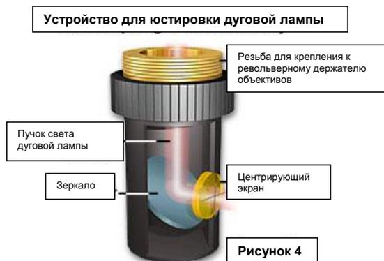
Независимо от способа юстировки дуги (с помощью вспомогательного устройства или белого листа бумаги, помещённого на предметный столик микроскопа) её изображение в обоих случаях проецируется из входного зрачка объектива, то есть из его задней апертуры. Когда объектив возвращён на своё место, изображение дуги в его задней апертуре расфокусировано, и освещение плоскости изображения (то есть полевой диафрагмы) оказывается равномерным. В этом и состоит суть освещения по Кёлеру.
