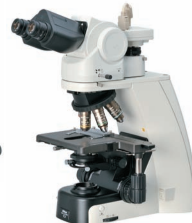
Ci-L с эргономичным бинокулярным тубусом и камерой серии DS
