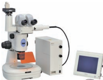
SMZ1500 в комплекте с эпифлуоресцентной насадкой P-FLA2 и DS-Fi1c-L3 камерой
