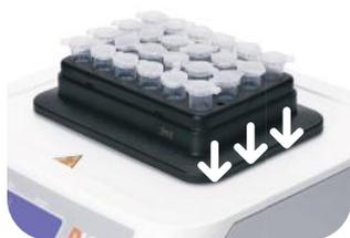
Быстрая замена адаптеров с помощью технологии магнитного сцепления без каких-либо инструментов
