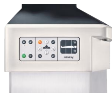
Резервная панель управления
