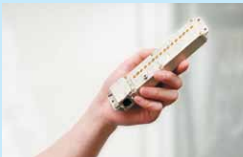
DirectDigital: миниатюрный блок электроники в катушке.
