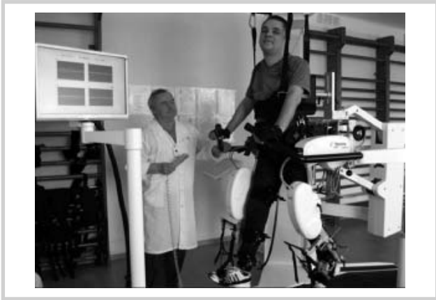
Рис. 2. Реабилитационный комплекс с беговой дорожкой и роботизированным ортопедическим устройством для локомоторной терапии Локомат («Носома», Швейцария).
