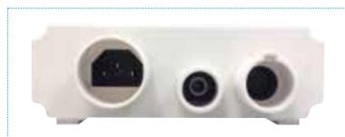
**Питание, разъем для подключения вызова медсестры и разъем для подключения функции «Bed Exit» (пациент встал с кровати) (модификация CGD 02)**
