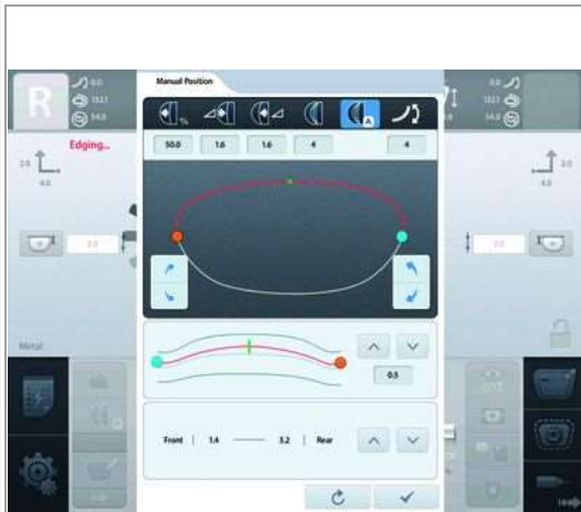
Step bevel (шаговый фанет) в процессе
