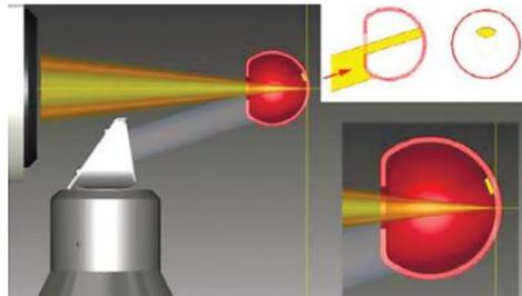
Оригинальный осветитель щелевой лампы с двумя разделяющими световой поток зеркалами
