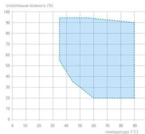
Указание: в рамках соответствующих диапазонов температуры и влажности возможна длительная эксплуатация (достигается при температуре окружающей среды  $22 \text{ }^\circ\text{C} \pm 3 \text{ K}$ ; относительная влажность воздуха  $< 50\%$ ). В пороговых диапазонах возможна конденсация. Количество конденсата зависит от степени влажности загружаемого материала, а также условий окружающей среды.
