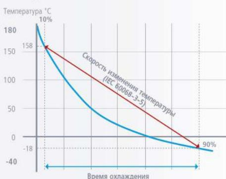
Согласно закону охлаждения Ньютона, зависимость скорости изменения температуры представляет собой экспоненциальную кривую. Этот параметр рассчитывается с соответствии с IEC 60068-3-5 при охлаждении от 90% до 10%. Таким образом, в верхнем температурном интервале скорость изменения температуры значительно больше, чем в нижнем.
