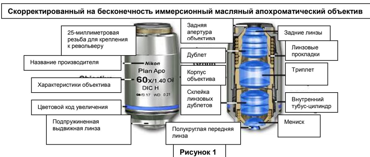
По конструкции и сборке объектив является наиболее сложным компонентом оптических микроскопов и первым компонентом, в который попадает свет на пути от образца к плоскости изображения. Своим названием объектив обязан тому факту, что по расположению он является ближайшим к наблюдаемому **объекту** (образцу) компонентом.
