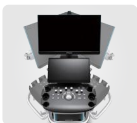
Вращающаяся панель управления
