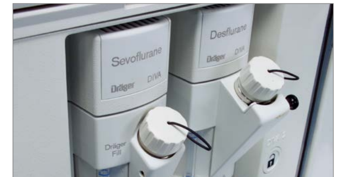
Электронное управление дозированием анестетика. Инжекторный принцип действия испарителя – прямой впрыск анестетика в контур вне потока свежего газа.
