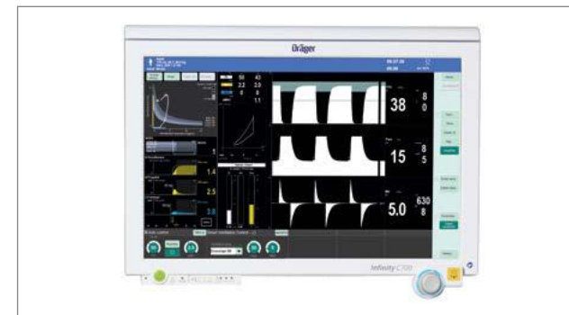
Дисплей с активным экраном высокого разрешения. Полоса визуальной индикации тревоги с обзором 360°.
