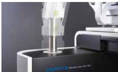
Регулировка по высоте кронштейна фороптора
