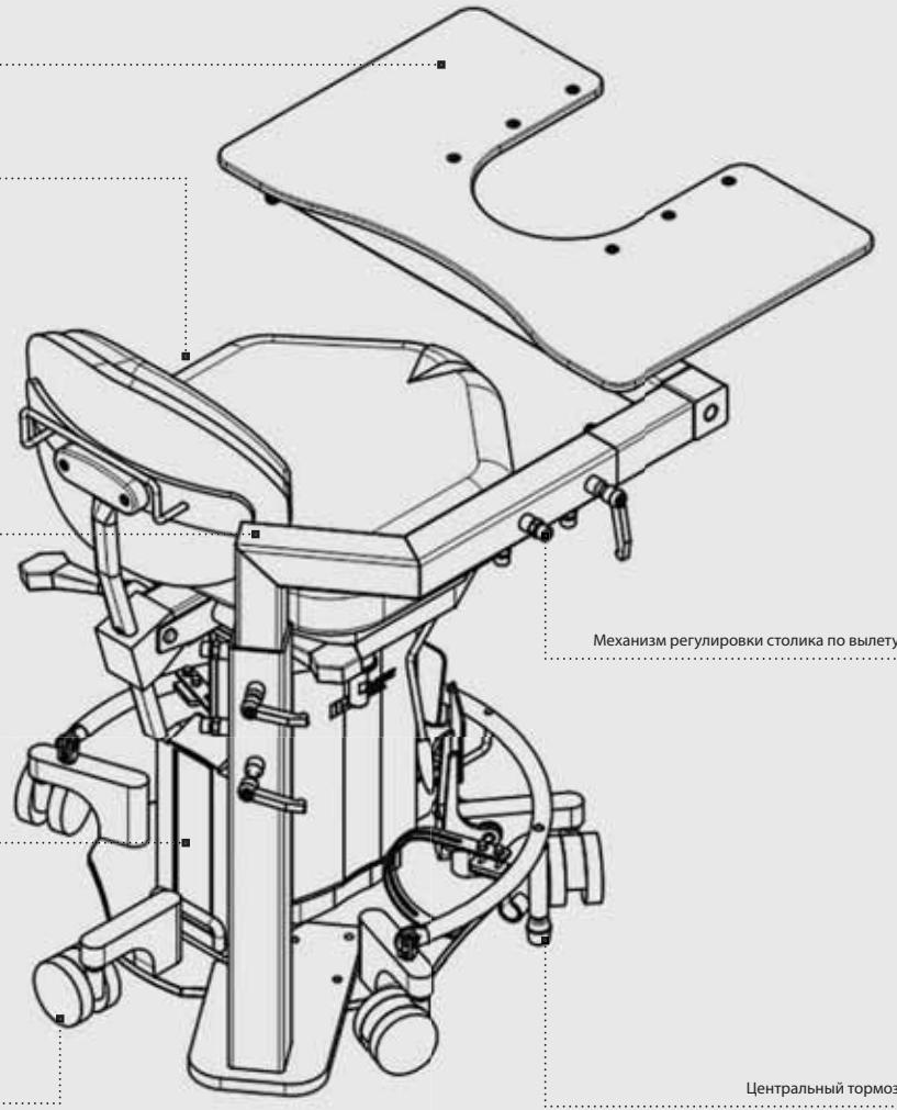
Механизм регулировки столика по вылету
