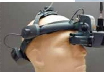
Непрямой офтальмоскоп с интегрированным модулем доставки лазерного излучения
