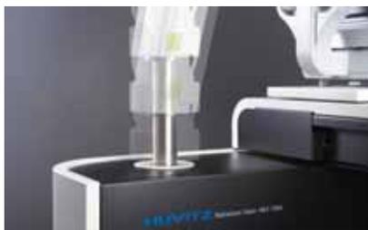
Регулировка по высоте кронштейна фороптора
