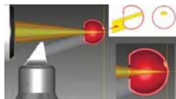
Оригинальный светильник щелевой лампы с двумя разделяющими световой поток зеркалами
