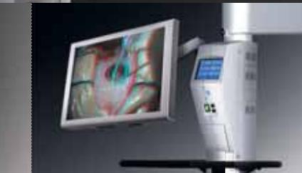
3D-монитор на штативе микроскопа
