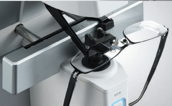
Измерение линзы в оправе
