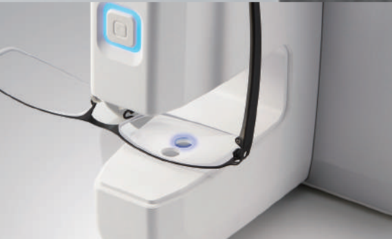
Измерение степени пропускания голубого и ультрафиолетового (UV) света
