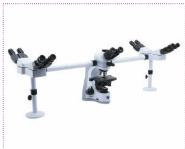
Микроскоп серии B-500 с модулями для обучения нескольких пользователей
