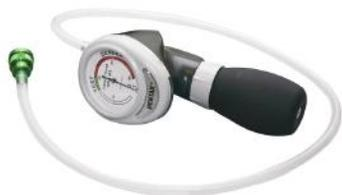
Тестер герметичности Pentax SHA-P5 применяется для проверки на дефекты внутренних каналов эндоскопа. Представляет собой механическое устройство с грушей для накачки давления, манометром и шлангом с коннектором для подключения к эндоскопу. Совместим со всеми эндоскопами Pentax.
