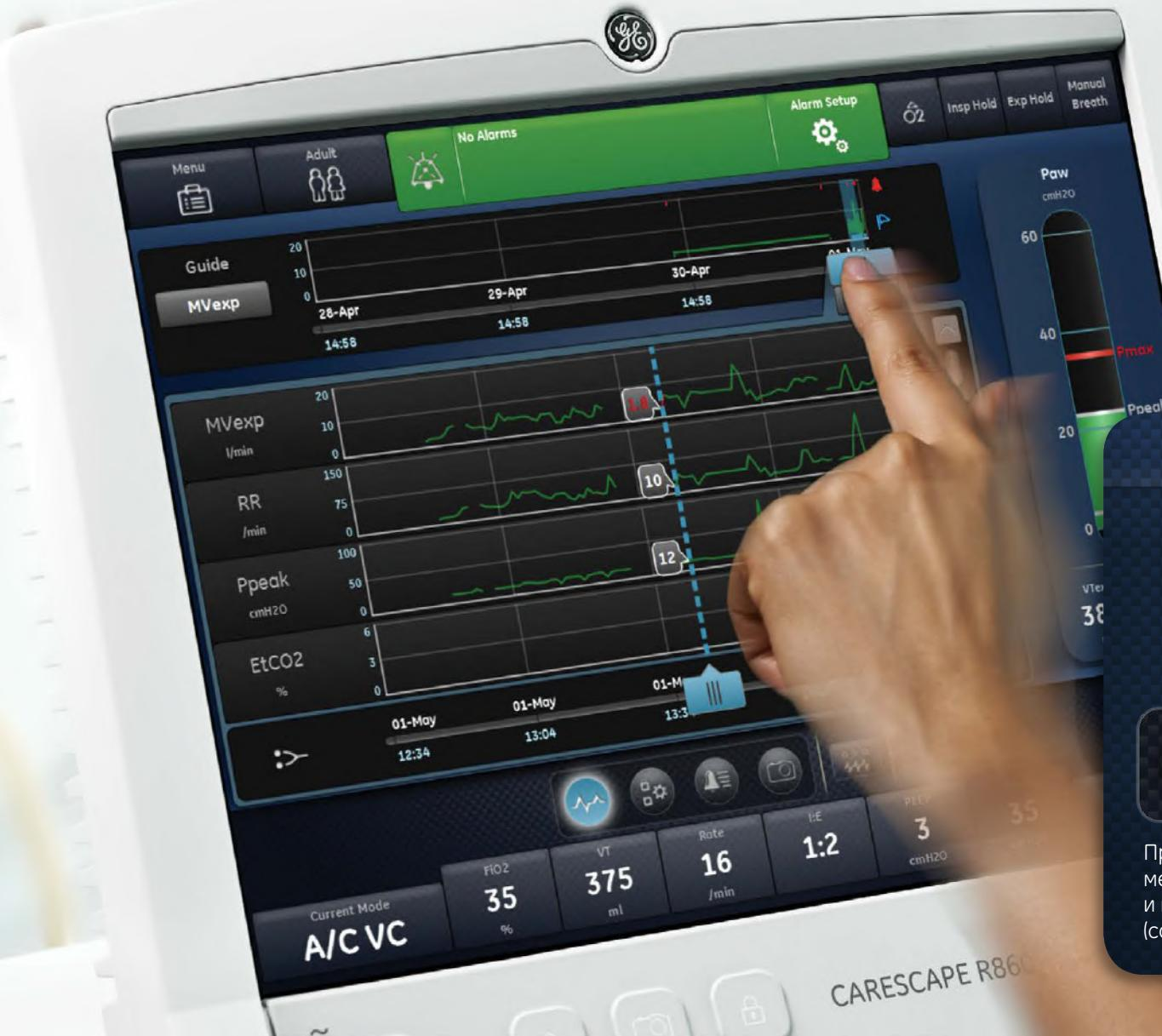
Благодаря пользовательскому интерфейсу аппарата CARESCAPE R860 вы теперь можете свободно переключаться между рабочими областями. Просто прикоснитесь к кнопке или выполните жест прокручивания, и вы перейдете к данным из прошлого (прокручивание влево) или будущего (прокручивание вправо), отображая тренды показателей вашего пациента и получая доступ к средствам защиты легких.
