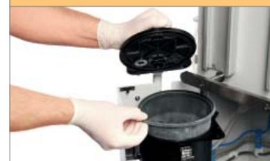
Вставьте диафрагму, установите корпус аппарата ИВЛ.
