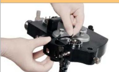
Установите затвор на линии забора смеси для анализа газового состава (опционально).
