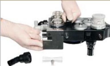
Присоедините ограничитель на датчике потока. Подключите датчик потока, подключите и плотно зафиксируйте порт выхода.
