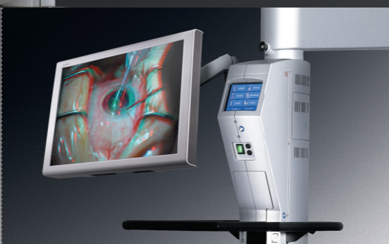
3D-монитор на штативе микроскопа (для обучения)
