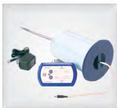
Система сигнализации о низком уровне жидкого азота
